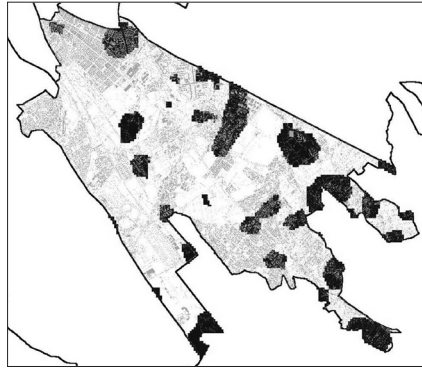
Fig. 17. Analisi della visibilità dalle torri esistenti, in nero le aree che risultano non visibili.
